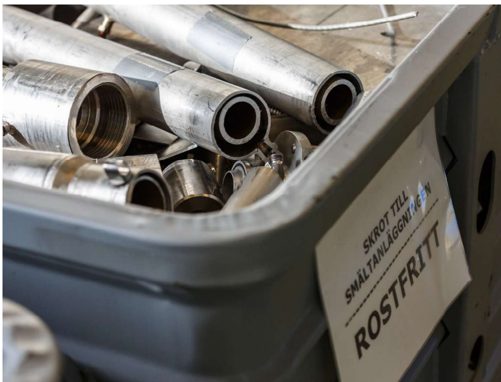
Figur 32. Utsorterad metall vid rivning, Källa: AB Svafo.
