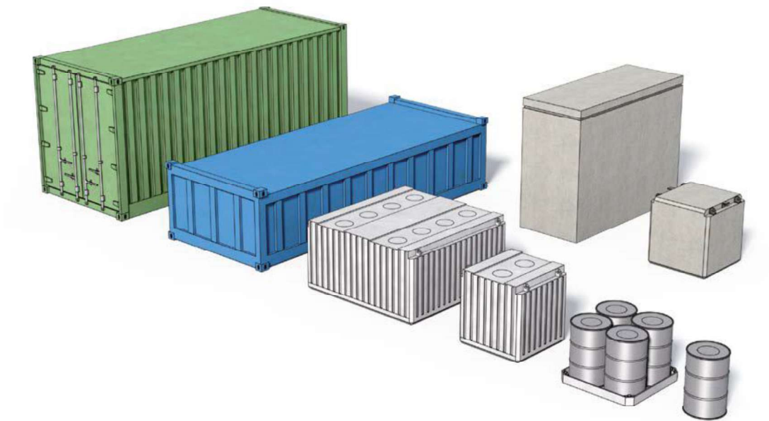
Figur 17. Exempel på avfallsbehållare. Främre raden: Helhöjdscontainer, halvhöjdscontainer, fyrkokill, plåtkokill, fatbricka, fat. Bakre raden: Betongtank, betongkokill. Det kan även finnas helhöjdscontainrar med halva längden (10-fotscontainrar).
